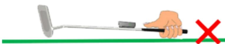
上り/下り、フック/スライスの測定は水平計測原理で、いろいろな種類のパターがあるので初期値0度に調整する必要がある。本体の水平計測には高い精度が必要のため、必ず初期セットアップの手順に従って水平補正を行うこと。
